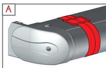
Antes de qualquer manipulação, é imperativo de colocar em segurança as extremidades do toldo. Amarrar simultaneamente, os braços, a barra de carga e tudo de enrolamento.
