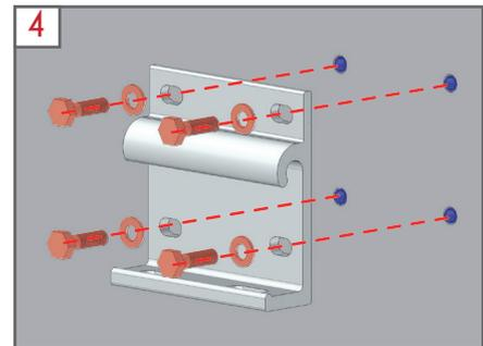
Fixação com parafusos 10mm. Kit de parafusos, cavilhas não facultadas.
